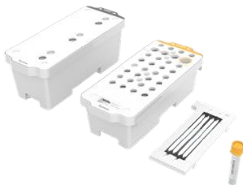
Фигура 3: Касетата с резервоара за реагентите, в който се добавят ДНК библиотеките от таргетните секвенции
