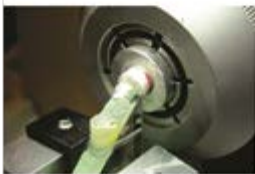
Фиг. 6. Полиране на образците с микроотом и стъклен нож
